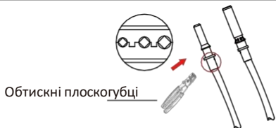
Мал. 3.4 Обтисніть контактний штифт до дроту
