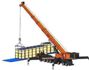
Розвантаження вертикальних упаковок з довгим боком за допомогою крана
