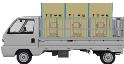
Малюнок 8 Надійно закріпіть модуль на вантажівці
